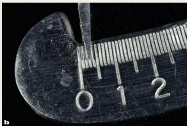
**Figura 8** El grosor de la superficie vestibular de la cofia de  $ZrO_2$  del diente número 12 se redujo a 0,3 mm para lograr el espacio necesario para un grosor máximo de la cerámica de recubrimiento.
