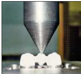
Figura 1 Ensayo por carga a tres puntos de una estructura de puente de tres piezas confeccionada con el sistema Cercon Smart Ceramics, empleando para ello una máquina universal de ensayo electromecánico modelo ME 405/10, con nº 1196 (Servosis®).
