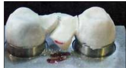
Figura 3 Imagen de la fractura del núcleo de puente de la probeta nº 5 del grupo Cercon® que muestra el patrón de fractura característico de las cerámicas: desde el lado gingival del conector hasta el centro del pónico.
