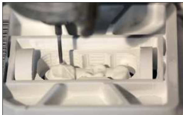
Fig. 4 Fresado de la estructura.
