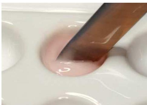
Figs. 32 a 34. La cerámica de fusión se mezcla sin formar burbujas aplicando una proporción de mezclado fija (1 gota de líquido: 1 porcionador de polvo).
