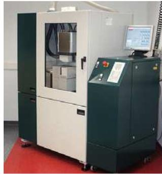
Fig. 2. Las fresadoras CAM Lava Form.
