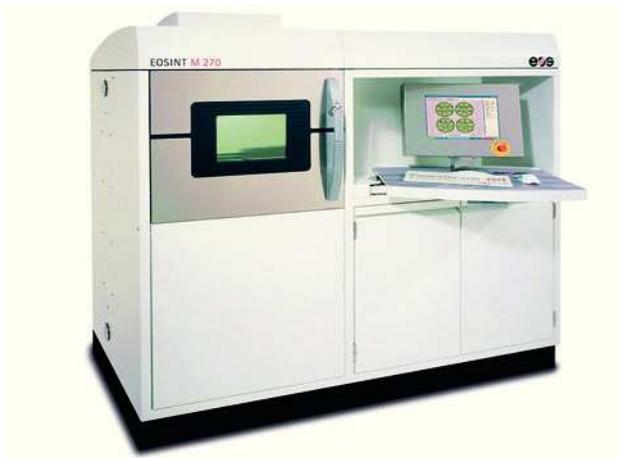
Fig. 4. Una instalación SLM de la empresa EOS (la más nueva generación de instalaciones SLM).
