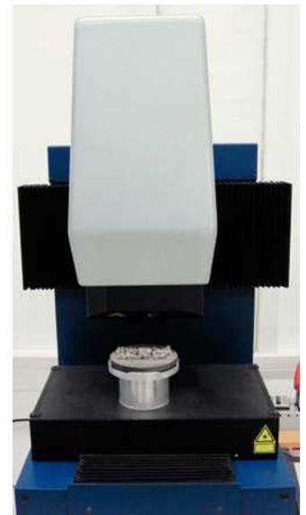
Fig. 8. Un escáner láser para comprobar la exactitud dimensional de las piezas producidas.
