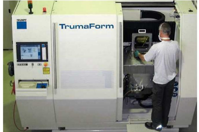
Fig. 3. Una instalación SLM de la empresa Trumpf (generación penúltima de instalaciones SLM).
