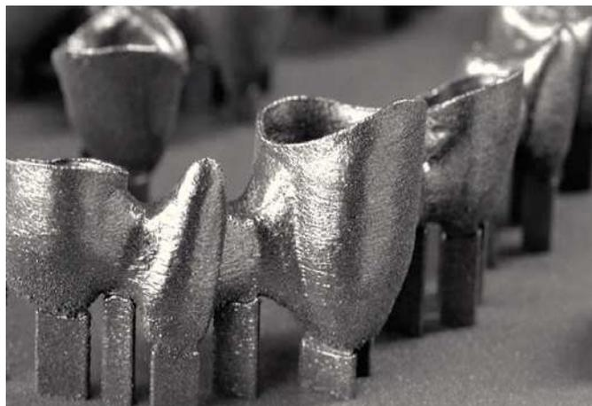
Fig. 7. Vista de los apoyos necesarios que impiden la rotura de las estructuras sobresalientes al aplicar el polvo.
