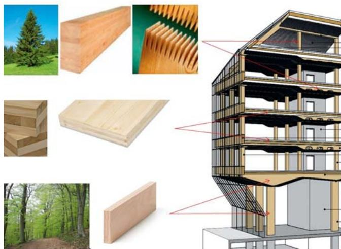
Figura 1. Uso actual de la madera como elementos estructurales
