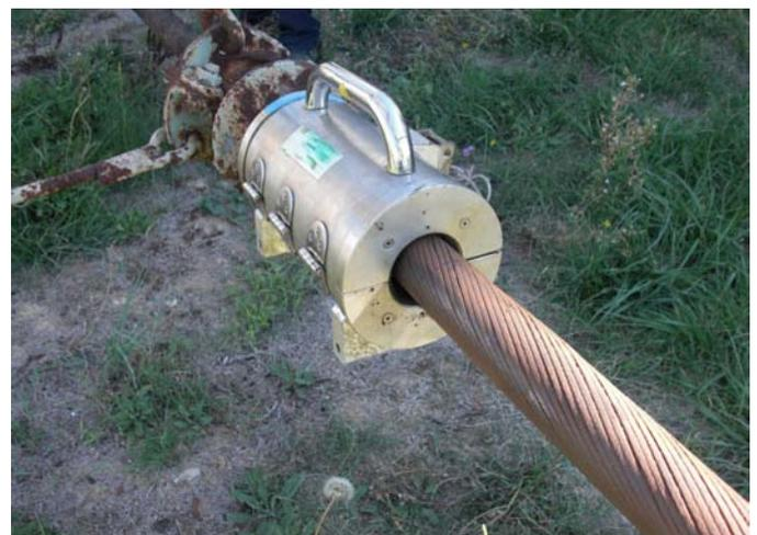
Inspección de cable por equipo magneto-inductivo
