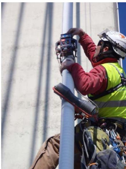
*Detección de oquedades mediante inspección con sonda capacitiva*
