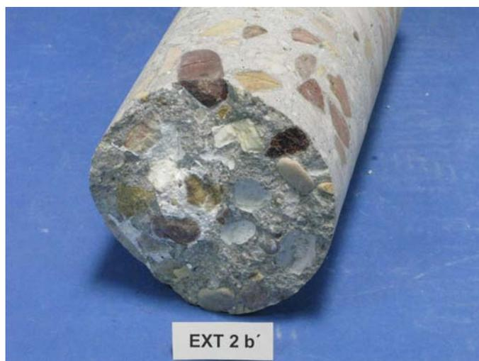
Depósitos blancos en la superficie de fractura
