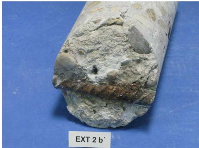
Depósitos blancos y armadura con corrosión
