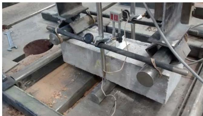
Figura 1. Ensayo de flexión en tres puntos
