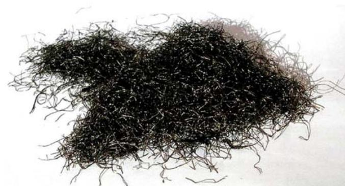
Figura 1. Fibras metálicas recicladas
