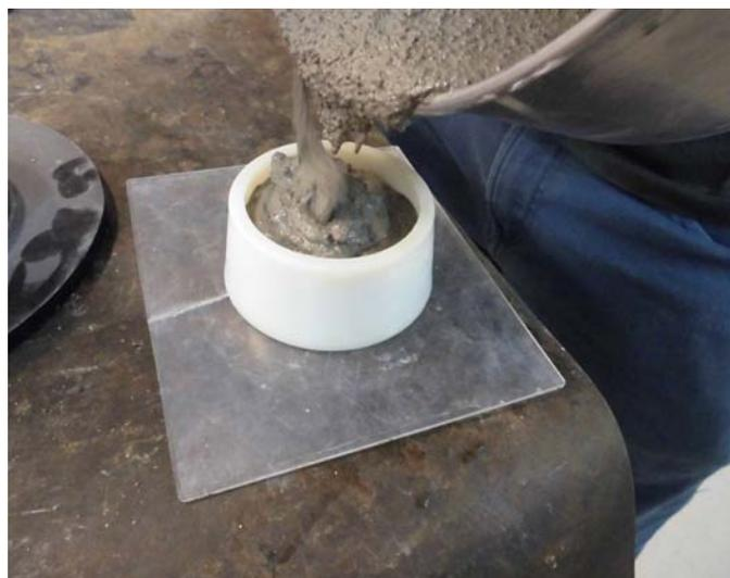
Figura 2. Ensayos para la evolución de la trabajabilidad
