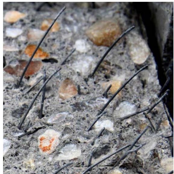
Fibras con anclaje arrancadas y rotas en la superficie de la fisura
