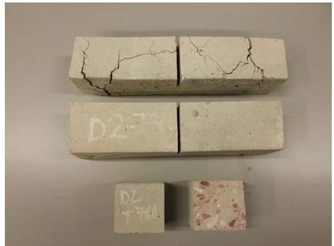
Hormigón enfriado tras ser sometido a 700 °C
