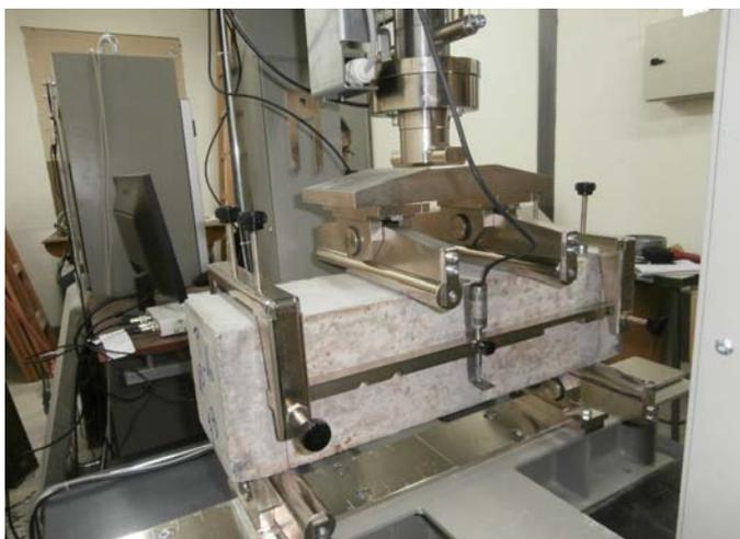
Resistencia a flexión por tracción (UNE 83510, 2004)
