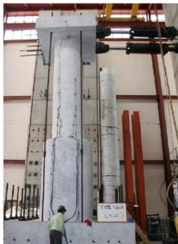
Pila sobre monopilete de sección ampliada y ensayo de laboratorio
