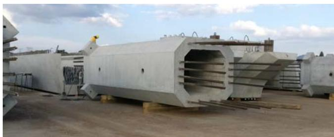
Industrialización de elementos estructurales de hormigón
