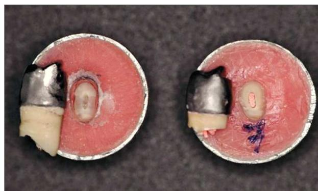
Figura 6. Dos ejemplos de especímenes valorados: (izquierda) modo de fractura con postes y muñones en aleaciones de oro; (derecha) modo de fractura con muñón de composite.
