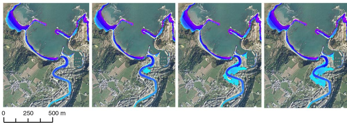
**Figura 10.** Inundación en Luarca para los escenarios E1 (panel izquierdo), E3 (panel en centro-izquierda), E8 (panel en centro-derecha) y E9 (panel derecho).
