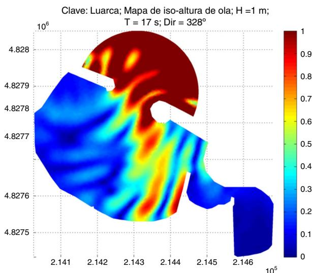
**Figura 7.** Variación de los coeficientes de difracción de la altura de ola dentro del Puerto de Luarca.
