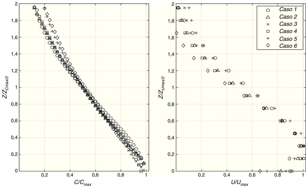
**Figura 9.** Autosimilitud de todos los perfiles transversales.
