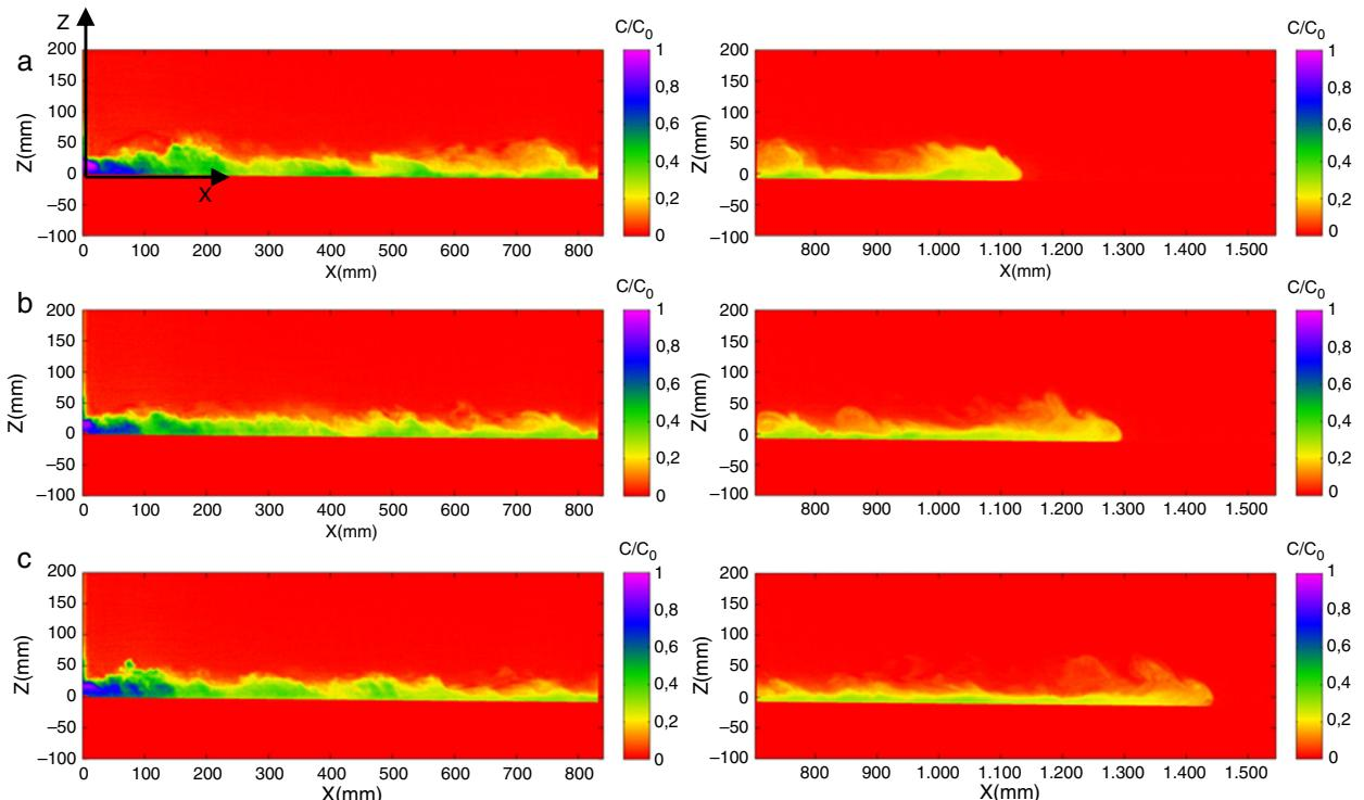
**Figura 5.** Campos instantáneos de concentración normalizada del CASO 1 de los instantes: a) 20 s; b) 30 s, y c) 40 s. Los campos de la columna de la izquierda corresponden a la cámara 1, y los de la derecha, a la cámara 2.
