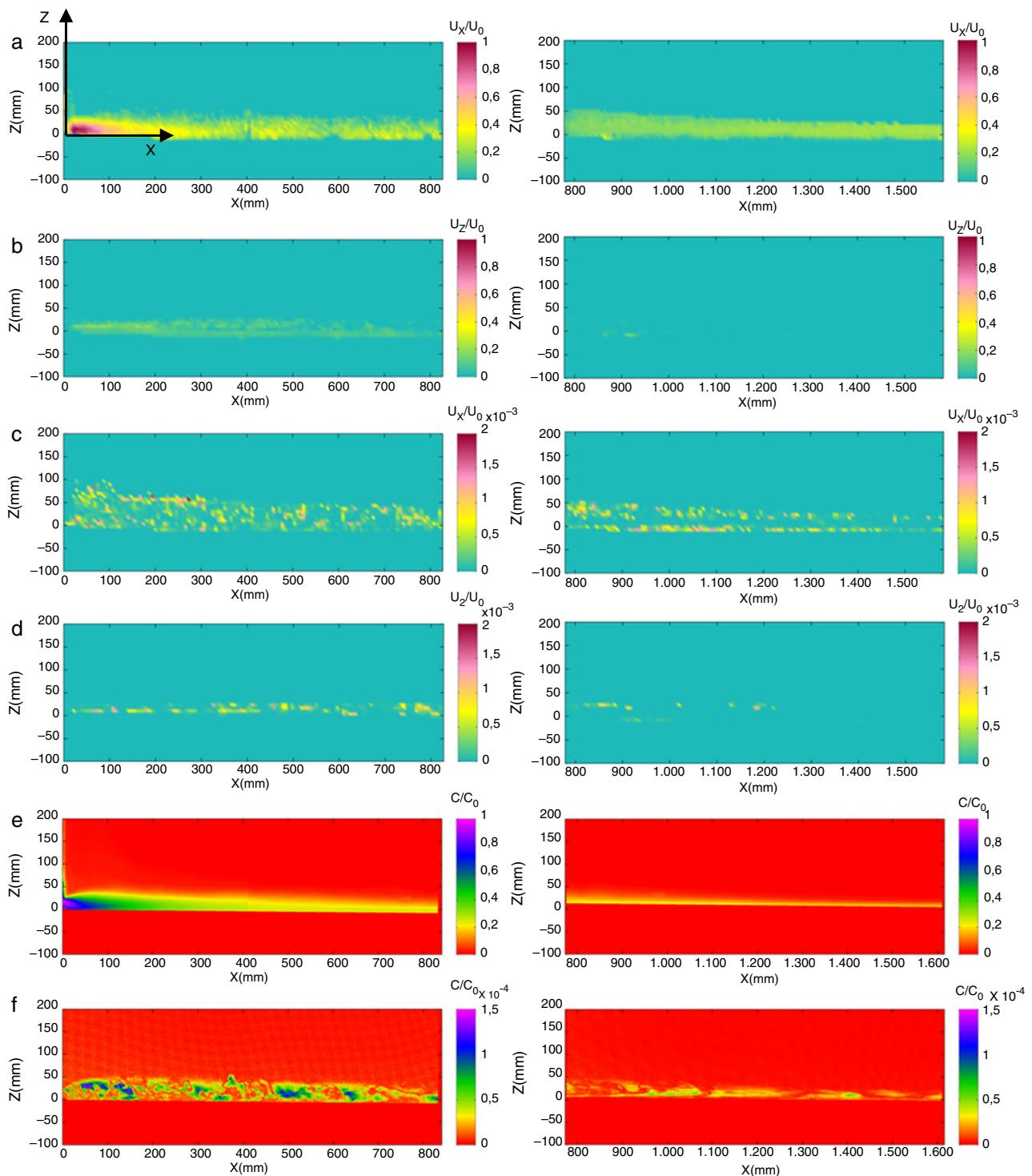
**Figura 6.** Campos medios de las variables normalizadas del CASO 1: a) velocidad media horizontal; b) velocidad media vertical; c) fluctuación de la velocidad media horizontal; d) fluctuación de la velocidad media vertical; e) concentración media, y f) fluctuaciones de concentración media. Los campos de la columna de la izquierda corresponden a la cámara 1, y los de la derecha, a la cámara 2.
