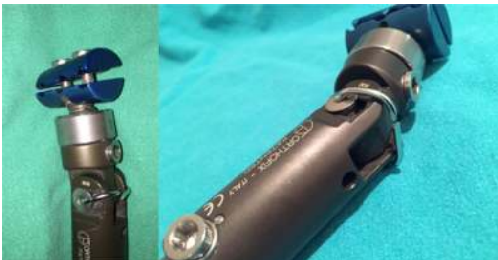
Figura 4 Rotura del fijador externo y solución mediante alambre de acero inoxidable, tanto a nivel de la bisagra principal, como de la unión al T-clamp.
