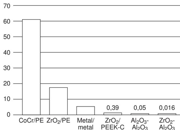
**Figura 2.** Desgaste volumétrico ( $\text{mm}^3/10^6$  ciclos) de diferentes pares articulares. Cr: cromo; Co: cobalto; PE: polietileno; PEEK: poli-éter-cetona; Zr: zirconio; Al: aluminio; O: oxígeno.
