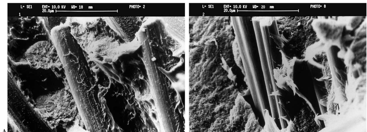
**Figura 1.** Materiales compuestos: A: la matriz de poli-éter-éter-cetona (PEEK) se adhiere íntimamente a las fibras de carbono, constituyendo un auténtico compuesto B: el polietileno de ultra alto peso molecular (UHMWPE) no se adhiere a las fibras de carbono, por lo que el material resultante no es un verdadero compuesto.
