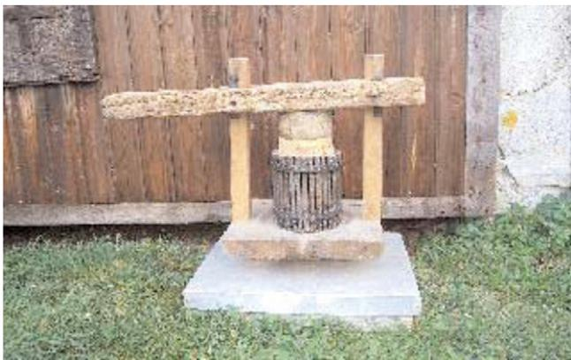
Figura 5. Prensa de viga. Fuente: Colección y foto de Albert Simon.
