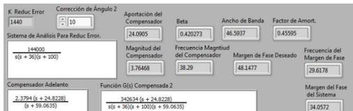
Figura 22: Parámetros de diseño del compensador en adelanto.
