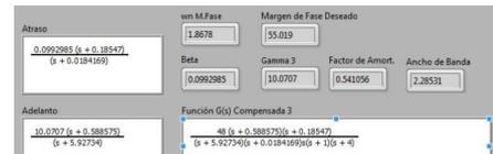
Figura 25: Parámetros de diseño de compensador en atraso-adelanto.
