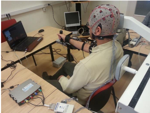
Figura 1: Exoesqueleto de miembro superior integrado con una interfaz cerebro-computador.
