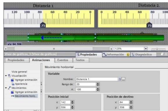
Figura 15. Configuración de la animación de la junta en la interfaz gráfica.
