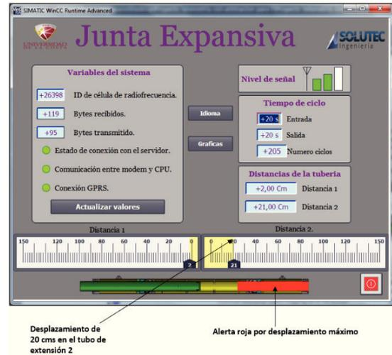
Figura 22. Registro de desplazamiento límite en la interfaz gráfica con alerta roja
