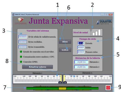
Figura 16. Interfaz gráfica para visualización del desplazamiento de los tubos de extensión.
