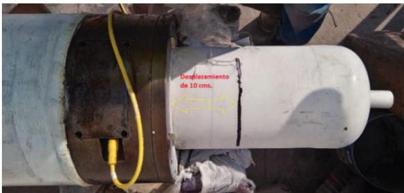
Figura 20. Marca de desplazamiento del tubo de extensión 2.
