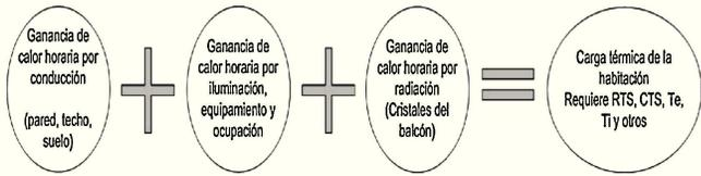
Figura 7: Estructura general del modelo aplicado.
