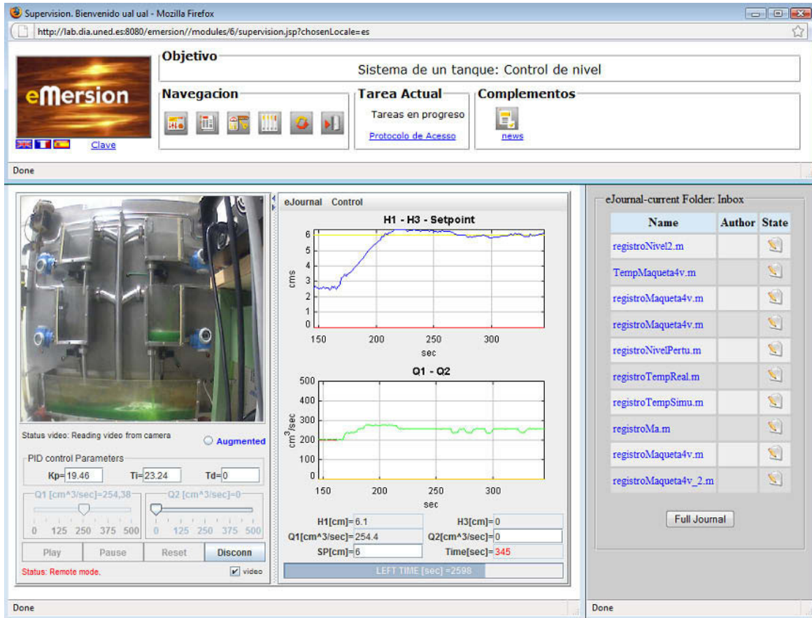
Figura 7. Laboratorios virtual y remoto de la maqueta de control de nivel
