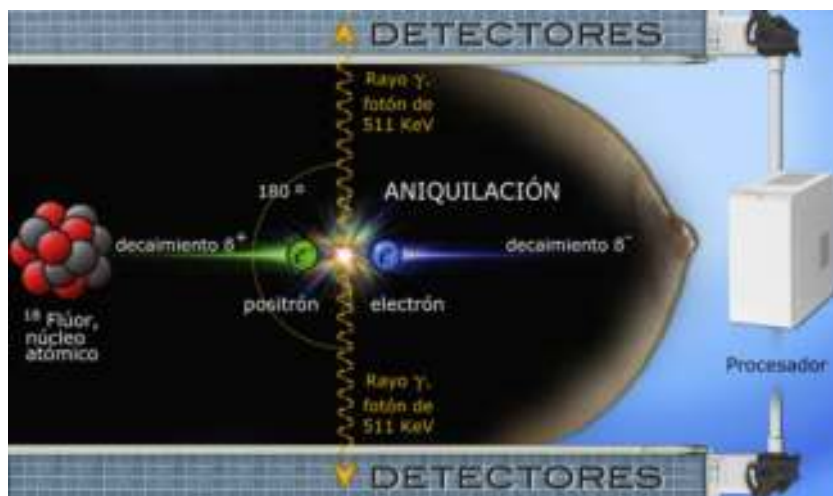
Figura 2 Ilustración esquemática de un evento de aniquilación dentro del tejido mamario. El equipo de PEM no detecta los positrones emitidos por el radiotrazador, sino los rayos gamma producidos al colisionar electrones y positrones. El decaimiento \beta^+ se refiere a la emisión de partículas beta desde un núcleo inestable para equilibrar su relación de protones y neutrones.
