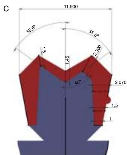
**Figura 4 – Modelo tipo 4 de treino da margem de acabamento cervical, parede axial, conicidade da parede axial, desgaste da face oclusal e bisel da cúspide funcional (A), respetivo calibrador (B) e relação do modelo integro tipo 4 com o respetivo calibrador (C).**
