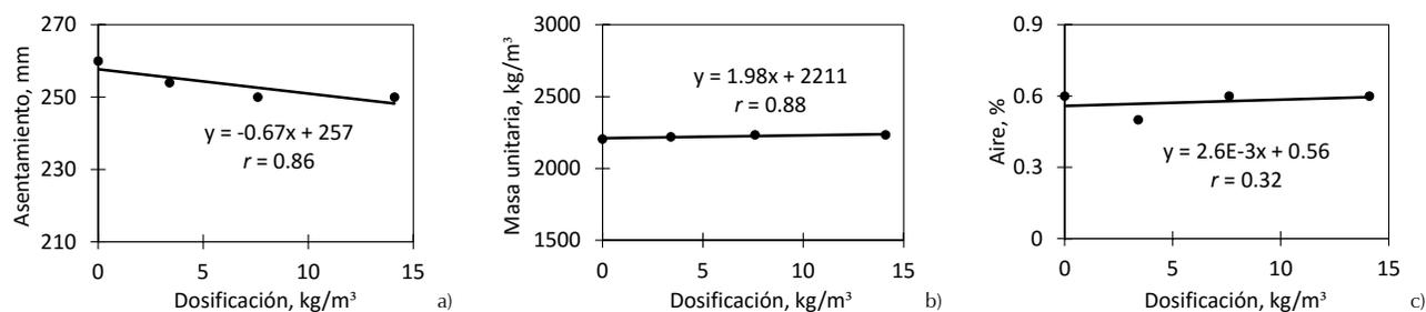
Figura 3. Propiedades del concreto en estado fresco: a) asentamiento, b) masa unitaria, c) contenido de aire
