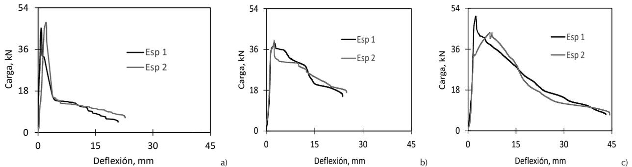
Figura 10. Curvas carga-deflexión de losas de CRFA: a)  $D_f = 3.4 \text{ kg/m}^3$ , b)  $D_f = 7.6 \text{ kg/m}^3$ , c)  $D_f = 14.1 \text{ kg/m}^3$
