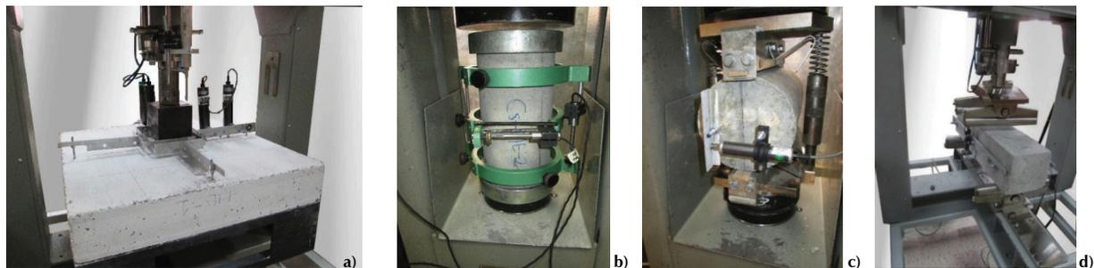
Figura 1. Configuración de ensayos: a) flexión de losas, b) módulo de elasticidad, c) tensión indirecta, d) flexión
