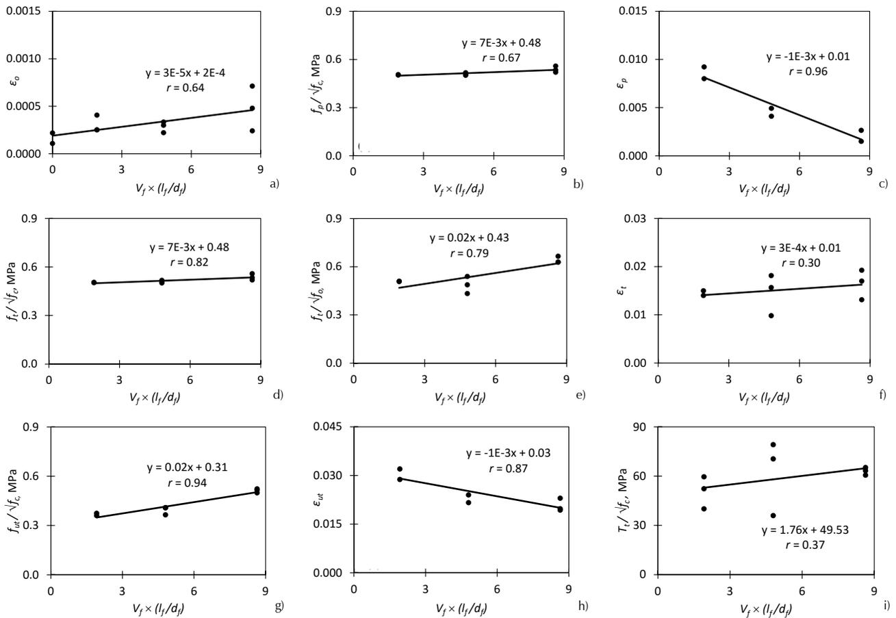
Figura 7. Tendencias de las propiedades mecánicas del concreto a tensión por compresión diametral del CRFA: a)  $\varepsilon_o$ , b)  $f_p/\sqrt{f_c}$ , c)  $\varepsilon_p$ , d)  $f_t/\sqrt{f_c}$ , e)  $f_t/\sqrt{f_o}$ , f)  $\varepsilon_t$ , g)  $f_{ut}/\sqrt{f_c}$ , h)  $\varepsilon_{ut}$ , i)  $T_t/\sqrt{f_c}$ .
