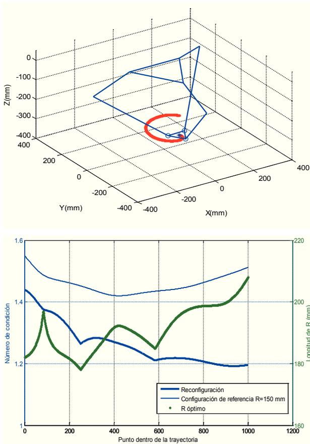
Figura 7. Optimización para una trayectoria, a) trayectoria de espiral 3D trazada bajo la configuración de referencia  $R = 150$  mm, b) comparativa entre el comportamiento del número de condición bajo la configuración de referencia  $R = 150$  mm y bajo la estrategia de reconfiguración planteada
