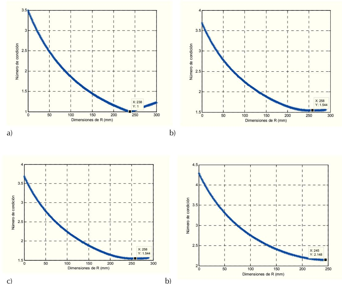
Figura 6. Relación entre el número de condición y la configuración del parámetro  $R$ , a)  $P = (0, 0, -375)$ , b)  $P = (120, 100, -375)$ , c)  $P = (-120, 100, -375)$ , d)  $P = (0, -220, -375)$
