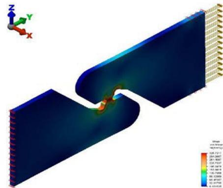
Fig. 4. von Mises stress for Erice specimen.
