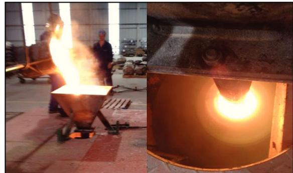
Fig. 5. Vazamento na centrifuga vertical.
