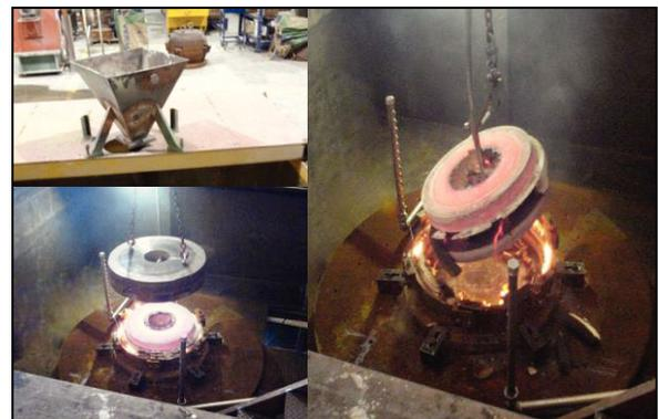
Fig. 6. Retirada da peça fundida por centrifugação.
