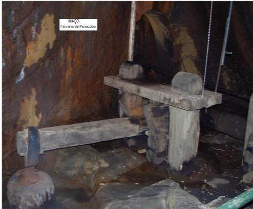
Fig. 5. Ferraria de Penacoba. Sistema de forjamento mostrando a bigorna e o martelo-pilão accionado por uma roda hidráulica situada no exterior.
