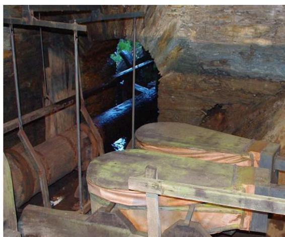
Fig. 4. Ferraria de Penacoba. Observam-se os foles para insuflação de vento nas forjas de reaquecimento dos lingotes, o sistema de accionamento e o eixo de ligação à roda hidráulica situada no exterior.
