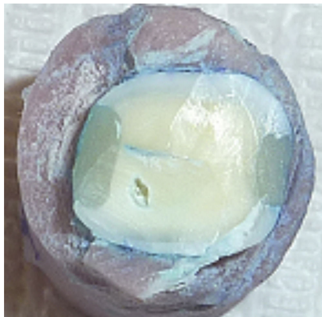
Figura 3 Corte transversal del cuerpo de prueba luego de termociclado, para medir la filtración marginal.
