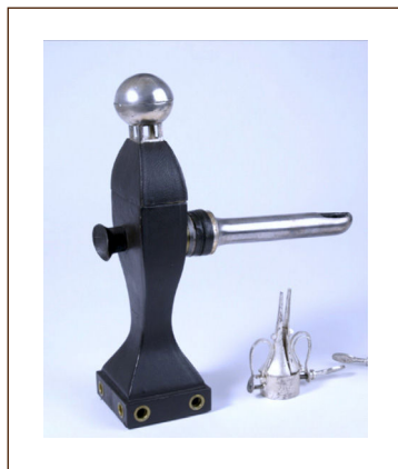
FIGURA 1. Conductor lumínico de Phillippe Bozzini. La fuente de luz era una vela
