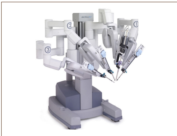
FIGURA 6. Carro paciente del Robot "Da Vinci" de Intuitive
