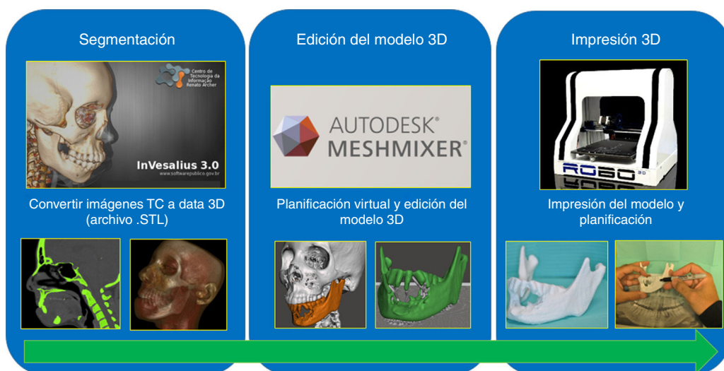
Figura 5 Resumen de los pasos para generar modelos de prototipado rápido con tecnología de impresión 3D.
