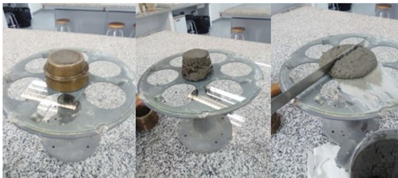
Figura 3 – Ensayo de determinación de la consistencia del mortero.
