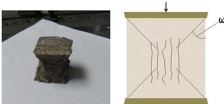
Figura 6 – Rotura típica de morteros de cemento.
