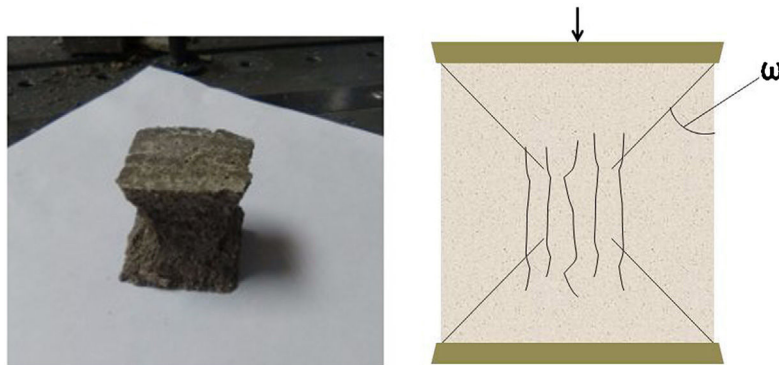
Figura 6 – Rotura típica de morteros de cemento.
