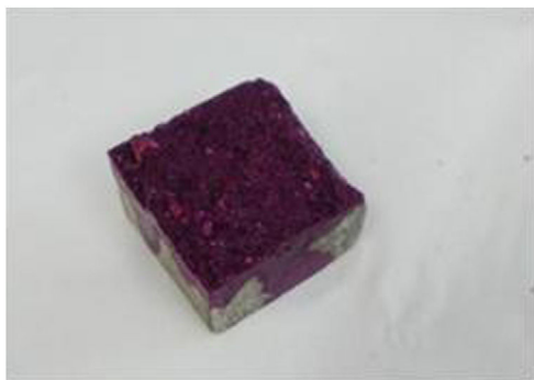
Figura 8 – Ensayo del test de fenolftaleína.
