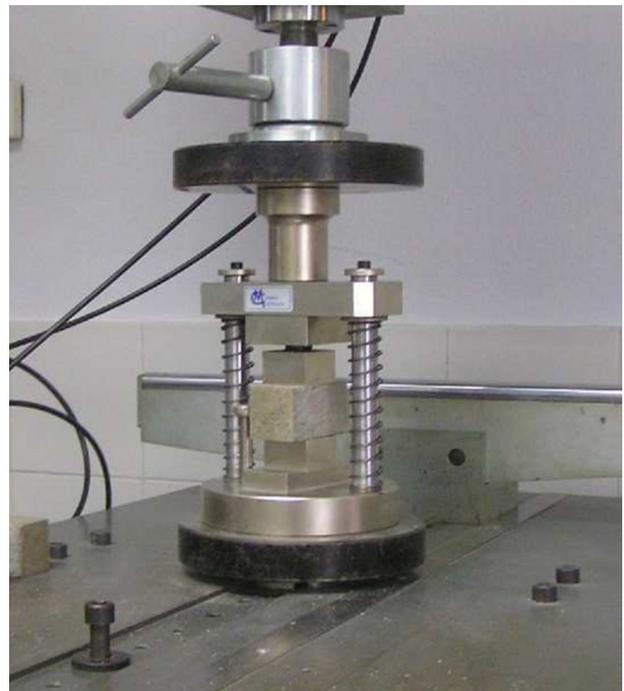
**Figura 4 – Dispositivo de ensayo a compresión.**
