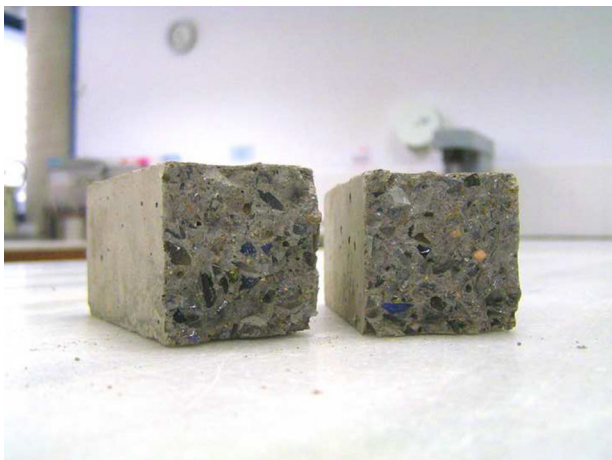
Figura 5 – Imagen de la distribución del agregado de vidrio triturado en el interior de las probetas de mortero (m50).
