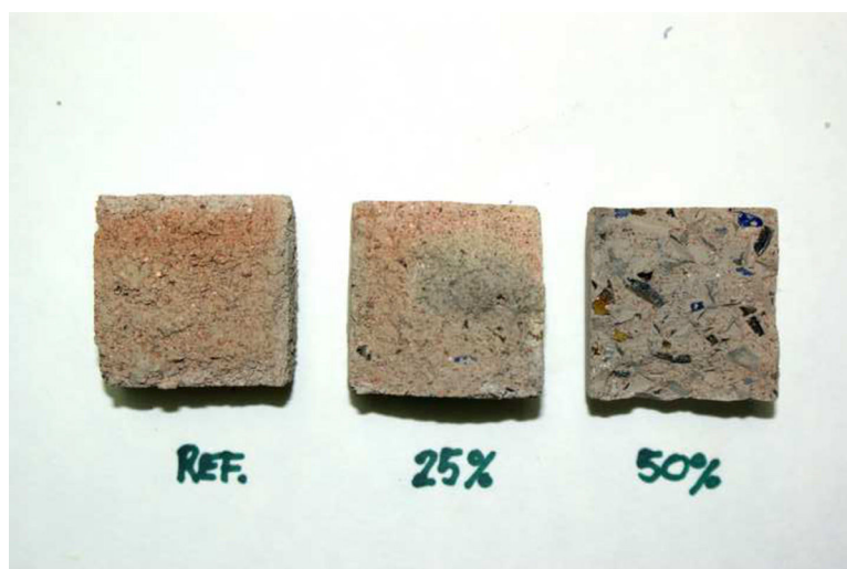
Figura 8 – Alteración cromática en las probetas tras el proceso de calentamiento a 800 °C.
