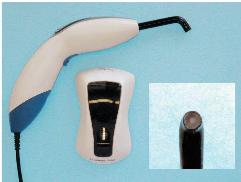
Figura 9. Lámpara de polimerización para el fraguado de resinas y radiómetro para la verificación del rendimiento de la lámpara de polimerización. Detalle: conductor de luz sucio.
