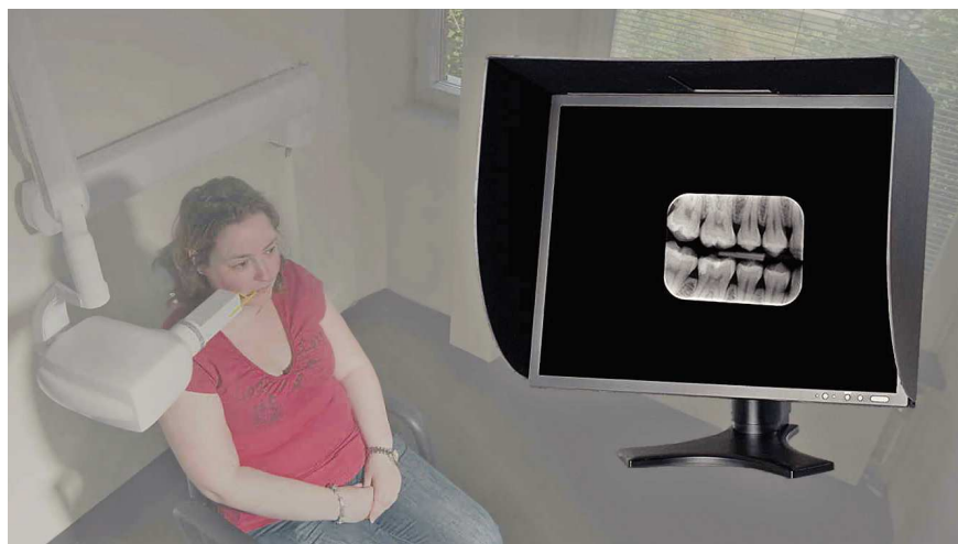
Figura 3. Imagen de una radiografía de aleta de mordida en una pantalla de PC. Para el diagnóstico, se debería trabajar con una pantalla dotada de una visera o en una estancia con una intensidad lumínica ambiente inferior a 50 lux. Debe ajustarse la pantalla para obtener un contraste y un brillo óptimos (foto: Jan Unneberg. Copyright® (2009) Nor Tannlegeforen Tid. Todos los derechos reservados).
