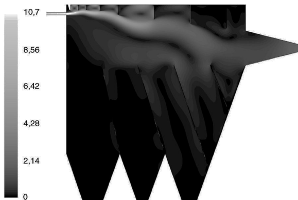
Figura 5. Representación de la magnitud de la velocidad (m/s) dentro del clasificador para una velocidad de entrada de 10 m/s.
