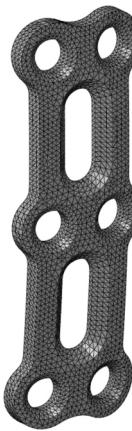
**Figura 5.** Placa de fixação utilizada na fusão cervical anterior.
