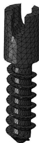
**Figura 6.** Parafuso poliaxial utilizado na fusão cervical posterior.
