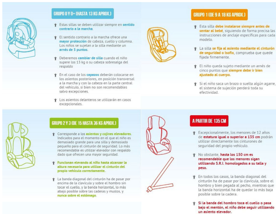
Figura 4 Grupos de sistemas de retención infantil (SRI) de acuerdo con las normas en vigor, y el peso y talla de los niños para los que se recomiendan.
