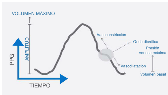
Figura 3 Forma de la onda fotopletismográfica y sus diferentes componentes relacionados con la fisiología cardiovascular del paciente.
