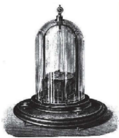
Figura 13. Galvanómetro astático de bobina fija e imán móvil, inventado por Nobili en 1825 (9).
