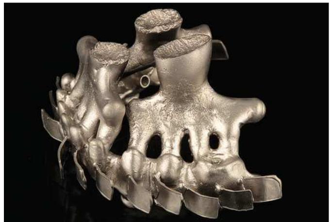
Fig. 19. Los jitos de colado separados y a medio llenar indican que ha afluido la cantidad suficiente de metal y que las fuerzas de deformación durante el enfriamiento son mínimas.
