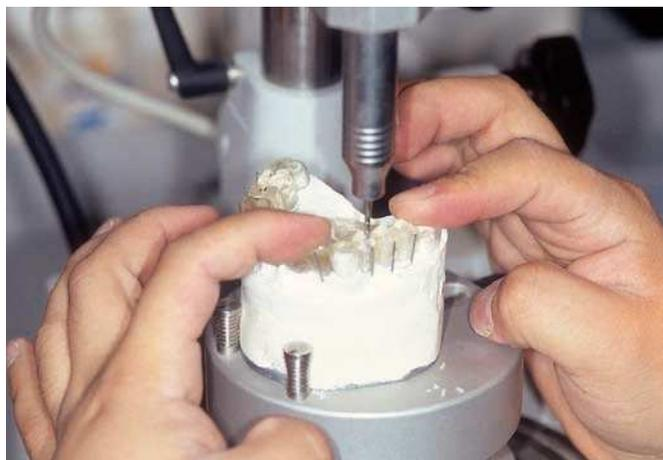
Fig. 9. Fresadora como ayuda paralela para fresar la plantilla quirúrgica.
