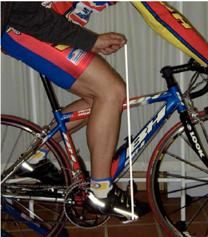
Fig. 16. El retroceso del sillín hará coincidir la vertical de rótula y eje del pedal.
