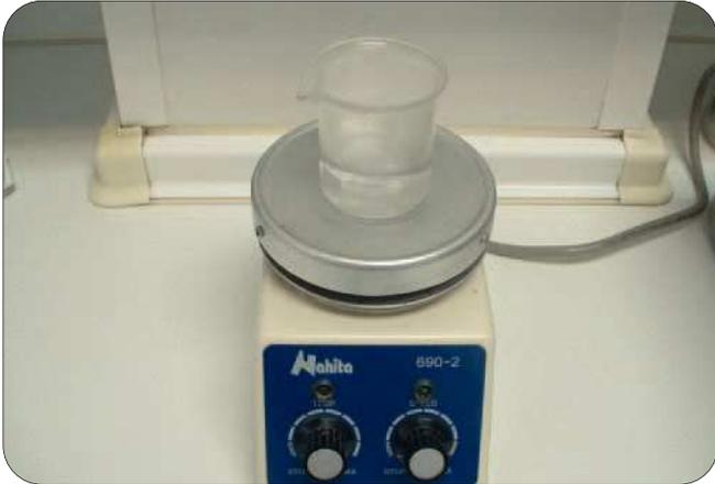
**3.** Agitar la mezcla en el agitador magnético a alta velocidad hasta lograr una perfecta disolución.
