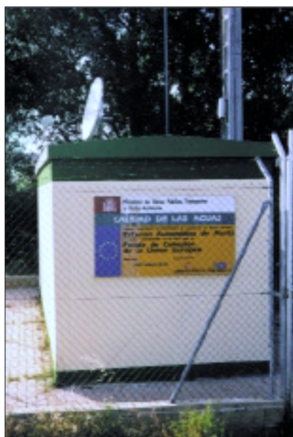
Esta estación automática de alerta, ubicada en el río Pisuerga, muestra la calidad del agua con dispositivos automáticos y conexión vía satélite al centro de control.
