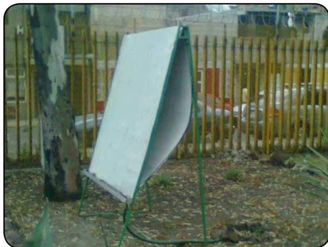
Foto 2. Atrapanieblas para la condensación de la humedad atmosférica y canalización del recurso hídrico para irrigar una planta, con el fin de facilitar su establecimiento.
