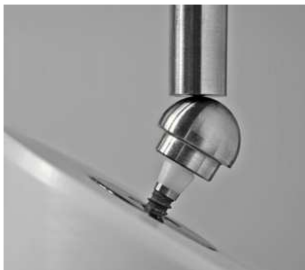
Figura 3 Modelo experimental coincidente con norma ISO 14801.
