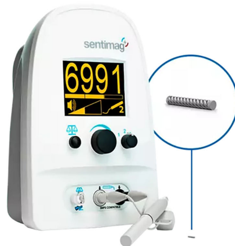
Figura 3 Sistema de detección Sentimag®-Magseed®. Sistema de detección Sentimag®, dispositivo con pantalla y sonda de detección y semilla ferromagnética Magseed®.
